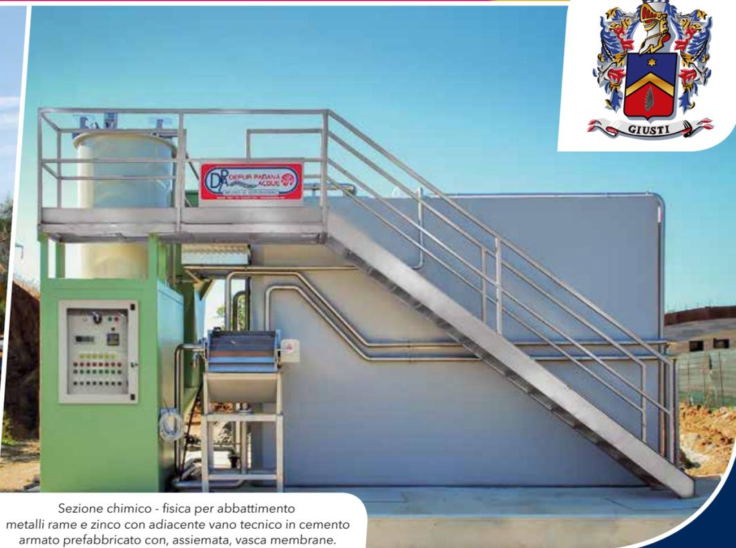
Sezione chimico - fisica per abbattimento metalli rame e zinco con adiacente vano tecnico in cemento armato prefabbricato con, assieme, vasca membrana.
