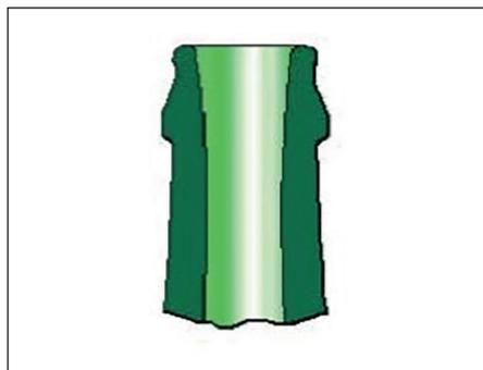
Figura C.15 – Collo della bottiglia con conicità inversa.
