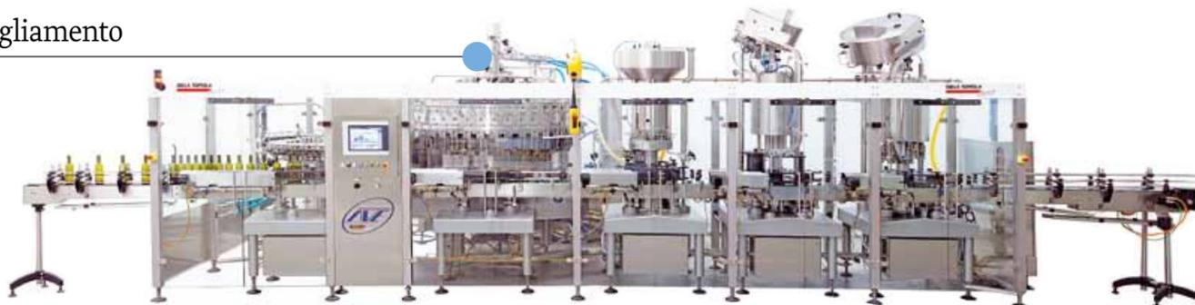
pressione e viene collaudato e certificato Ped a 9 bar. Le stelle brevettate di trasferimento permettono di evitare il cambio formato nell'impiego di bottiglie cilindriche e leggermente coniche con diam. 50 - 100 mm. La modularità degli impianti consente anche la sincronizzazione con l'etichettatura per un risparmio di spazio, oltre alla possibilità
